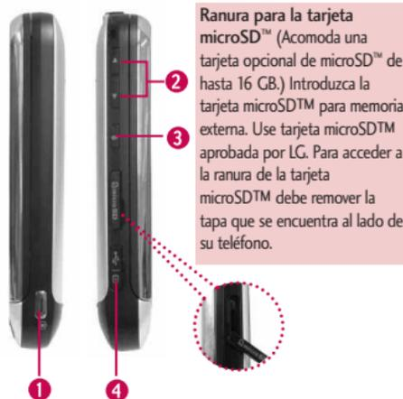
1. **Tecla lateral de Cámara** Úsela para acceder rápidamente a las funciones de Cámara y Video.
